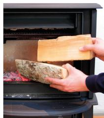
**Toujours garder la charge de carburant sous le tube d'air secondaire le plus bas. L'espace devant et au-dessus du tube à air le plus bas est réservé à la combustion de gaz volatil.**
