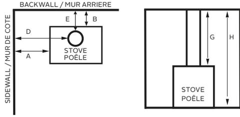
Profondeur maximale de la niche: 32" (813mm)
