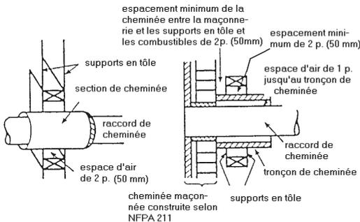
A. Maçonnerie en briques charpentée d'au moins 3,5 pouces (90 mm) d'épaisseur dans un mur inflammable avec une séparation en brique de 12 pouces (305 mm) minimum de la doublure en argile aux combustibles. La doublure en argile réfractaire doit aller de la surface de la sortie du mur en brique jusqu'à la surface interne de la doublure du tuyau de cheminée mais pas au delà et doit être solidement cimentée en place.
