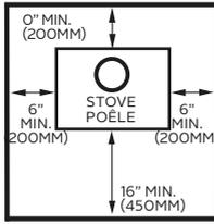
LE PROTECTEUR DE PLANCHER DOIT ÊTRE D'UN MATÉRIEL INCOMBUSTIBLE. IL DOIT S'ÉTENDRE EN DESSEUS DE L'APPAREIL ET AU DEVANT, AUX CÔTÉS ET À L'ARRIÈRE DE L'APPAREIL COMME INDICQUÉ.
